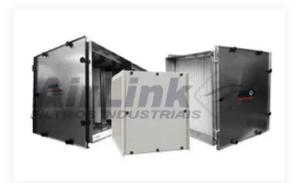
As caixas de filtragem são dimensionadas de acordo com as vazões dos equipamentos e os tipos de filtros a serem utilizados. As caixas **modelo AL-CGF** foram especialmente projetadas para acondicionar 02 estágios de filtragem (filtros grossos – G1 a G4 e filtros finos – M5 a F9 NBR 16101) oferecendo grande eficácia, praticidade na instalação e agilidade na manutenção.
